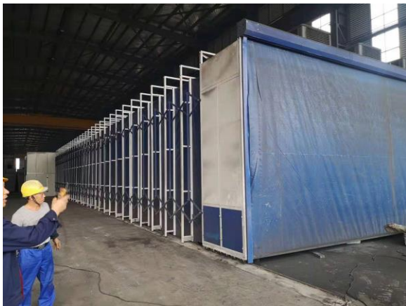
移动喷漆房现场图
